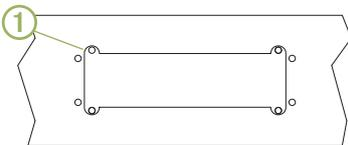
**5** Setzen Sie das Radio in den Ausschnitt, um den Freiraum der Schrauben zu testen.
